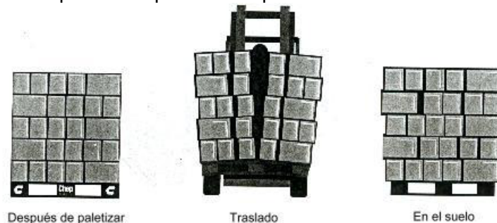
Imagen 26. Transporte de estiba no paletizada
