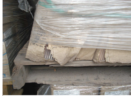
Imagen 48. Cajas y productos dañados por mal almacenamiento
